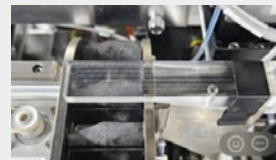
<에러발생부위> 장비에 반응용 cuvette을 공급하는 부위
